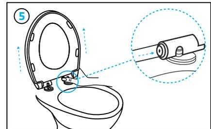
Una vez que el asiento esté alineado y asegurado, presione los botones de liberación rápida y levante el asiento para liberarlo del soporte de montaje.
