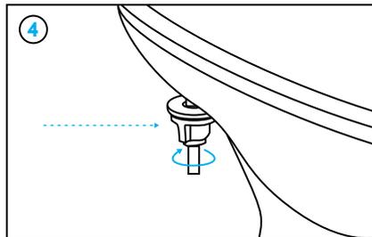
Serrez les boulons situés sous la cuvette des toilettes jusqu'à ce que le siège soit solidement maintenu.
