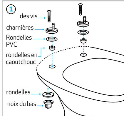
Insérez les composants dans les trous en céramique de votre cuvette de toilette dans l'ordre indiqué. Fixez par le fond du bol. Ne serrez pas trop les charnières ; ils doivent rester lâches pour permettre un bon alignement du siège.
