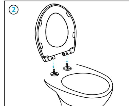
Insérez les axes de charnière dans le siège.
