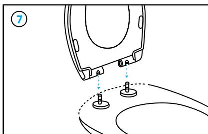
Pour clipser le dossier du siège sur le support de montage, placez le siège sur les goupilles et poussez le siège vers le bas.
