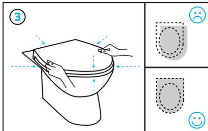
Fermez la housse du siège (ne forcez pas). Redressez l'avant du siège et les bords pour les aligner avec les bords du bol.
