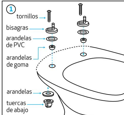
Inserte los componentes en los orificios de cerámica de la taza del inodoro en el orden que se muestra. Sujete desde el fondo del recipiente. No apriete demasiado las bisagras; deben permanecer sueltas para permitir la alineación adecuada del asiento.
