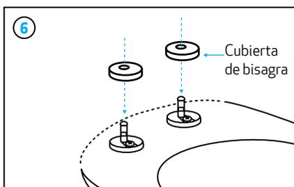
Retire cualquier película protectora de las cubiertas de las bisagras y colóquelas sobre el pasador de la bisagra para cubrir la bisagra.
