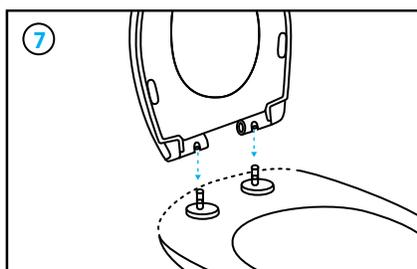
Para sujetar el respaldo del asiento al soporte de montaje, coloque el asiento sobre los pasadores y empujelo hacia abajo.
