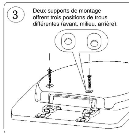
3) Fixez le siège sur la cuvette. Choisissez les trous sur les supports de montage qui s'alignent le mieux sur les trous de fixation du siège sur la cuvette. Insérez des vis dans les trous et les boulons d'ancrage expansibles sans serrer.
