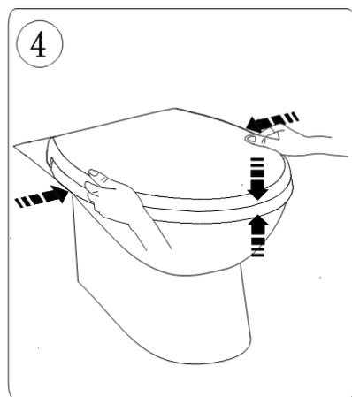
4) Ajustez la position du siège afin qu'il soit aligné sur la cuvette.
