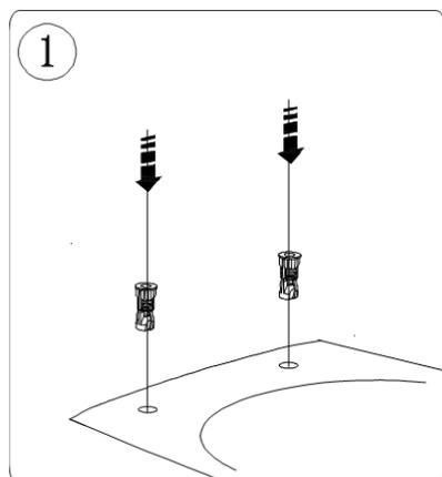
1) Insérez puis enfoncez les charnières en plastique extensibles dans les trous de fixation du siège et de la cuvette jusqu'à ce qu'elles soient à ras avec la surface.
