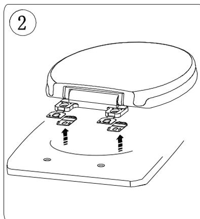
2) Insérez des rondelles de caoutchouc au fond des charnières du siège.
